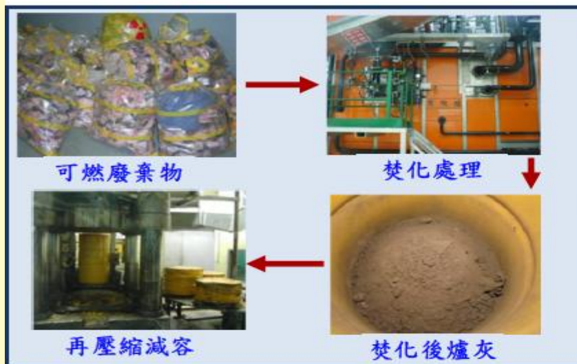
焚化及壓縮設施 (核能後端處減容中心)
